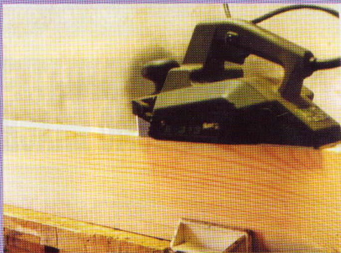
Фото 2. Профугуємо торці дошок, стежачи за тим, щоб вони були під кутом 90° до площини дошки, що, працюючи ручним інструментом, у початківця не відразу виходить.
